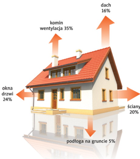
Rys. Schemat strat ciepła w budynku jednorodzinnym
