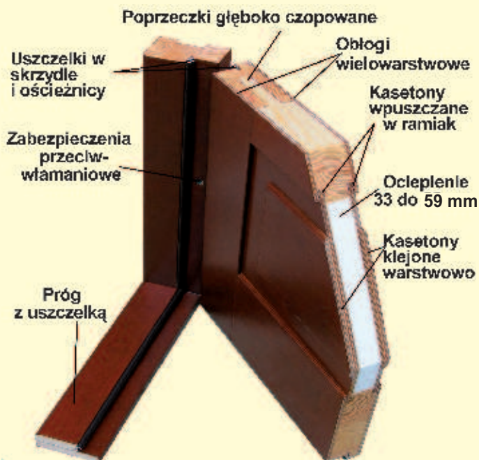
Przekrój drzwi maksymalnie ocieplonych o grubości skrzydła 59 mm lub 72 mm
