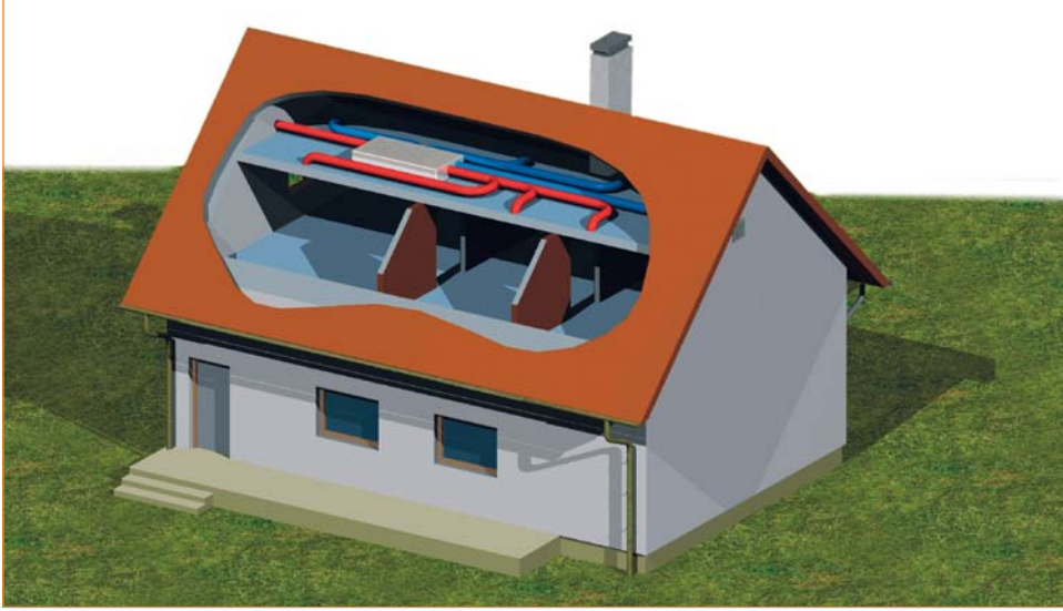
▲ Przestrzeń pod dachem warto wykorzystać na montaż rekuperatora. Dzięki grubej warstwie wełny mineralnej zamontowanej w stropie, praca urządzenia nie będzie słyszalna na poddaszu
