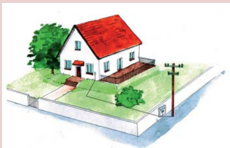
Przyłącze kablowe z linii napowietrznej
