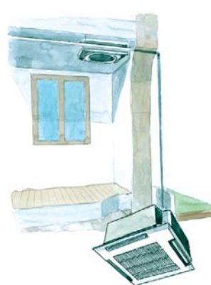
M iędzystrypowy (kasetonowy). Często stosowany w pomieszczeniach z podwieszonym sufitem. Może mieć kilkukierunkowy nawiew.
