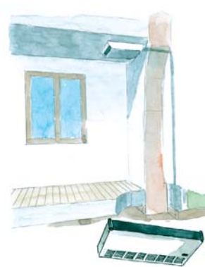
P odstrypowy. Idealnie nadaje się, gdy nie ma miejsca na ścianie. Może mieć nawiew w jednym lub kilku kierunkach.
