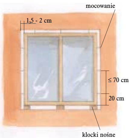
3 Okno musi opierać się na klockach nośnych umieszczonych pod każdym pionowym profilem
