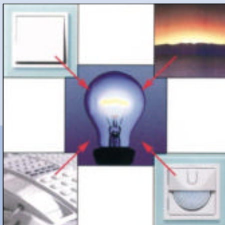
9 Oświetlenie zależy od obecności mieszkańców, zachmurzenia i pory dnia. Sterowniki mogą być nadzorowane zdalnie – przez telefon (fot. Peha)
