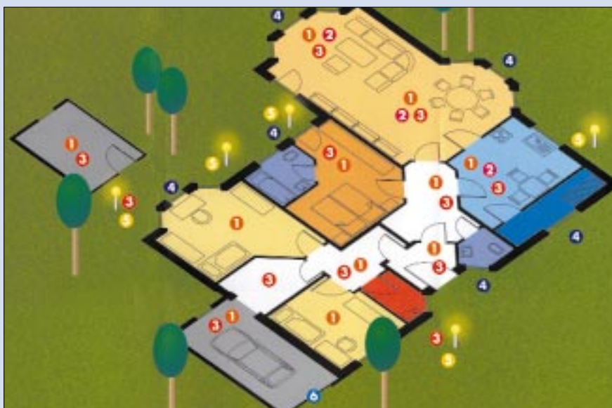
1 Przykładowe elementy wchodzące w skład domu inteligentnego (fot. Peha): 1-sterowanie oświetleniem, 2 – sceny świetlne, 3 – przyciski alarmowe, 4 – sterowanie roletami i markizami, 5 – sterowanie instalacjami ogrodowymi, 6 – sterowanie wyposażeniem garażu
