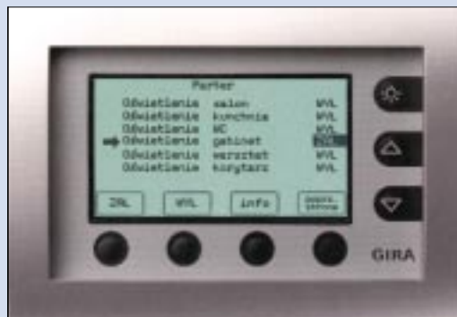
7 Interaktywny wyświetlacz umożliwiający sterowanie urządzeniami wchodzącymi w skład systemu (fot. Gira)
