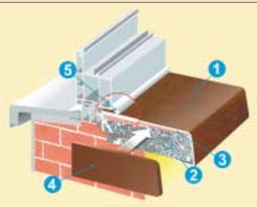
6 Renowacja parapetu z zastosowaniem nakładki z PVC (fot. Parapety): 1. parapet renowacyjny z PVC; 2. stary parapet; 3. spoiwo; 4. zakończenie boczne; 5. ćwierćwalek.
