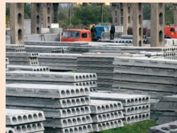
Płyty kanałowe mają dobrą izolacyjność akustyczną (fot. Prefabet Elk)
