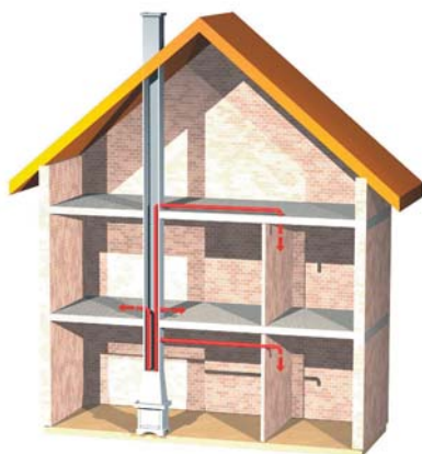
Gdy poziome odcinki kanałów systemu DGP są długie, obieg powietrza musi wspomóc wentylator. Inaczej ciepłe powietrze nie dotrze do wszystkich pomieszczeń
