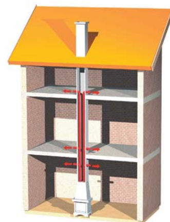
W wąskim i wysokim domu wystarczy grawitacyjny obieg gorącego powietrza, bo poziome odcinki kanałów są bardzo krótkie
