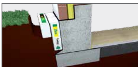
5 Ustawiamy kolejną warstwę worków.
