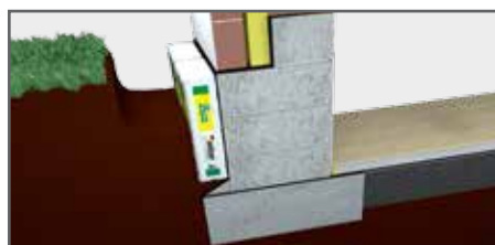
4 Zасыпуем wykop do poziomu, na którym planujemy postawienie kolejnej warstwy worków.
