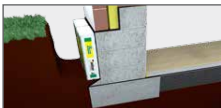
3 Ustawiamy pierwszą warstwę worków z keramzytem bezpośrednio przy ścianie budynku.
