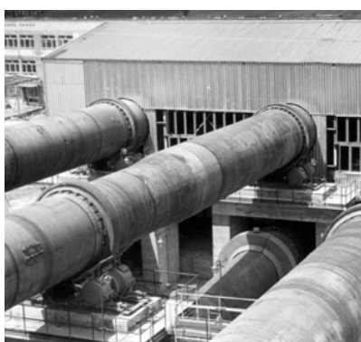
Piece obrotowe do produkcji keramzytu na zdjęciu z lat 70-tych (fabryka w Gniewie)
