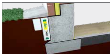
6 Uzupełniamy grunt i wykonujemy ew. opaski betonowe, nawierzchnie itp.
