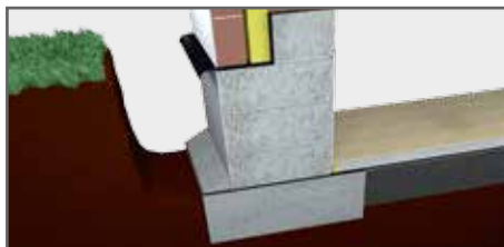
1 Oczyszczamy wykop przy budynku.
