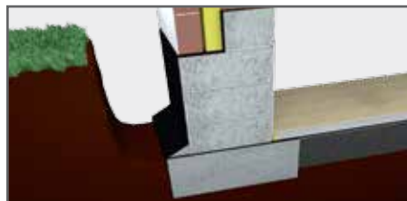
2 Na ścianie budynku wykonujemy izolację przeciwwilgociową.
