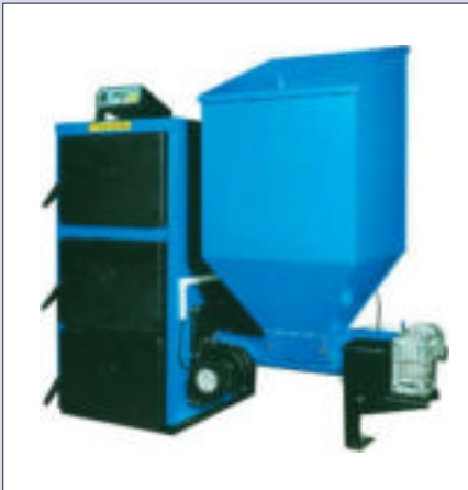
8 Kocioł o mocy 25 kW z paleniskiem retortowym; obsługa sprowadza się do napelniania kosza zasypowego paliwem – podstawowe: węgiel kamienny groszek 8-20 mm, zastępcze: groszek 8-31,5 (fot. ZGM Zębice)
