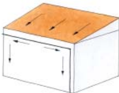
I Odwadnianie dachu jednospadowego
