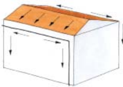
II Odwadnianie dachu dwuspadowego
