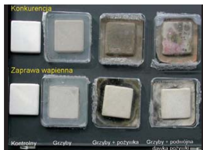
1 Badanie podatności materiałów na korozję biologiczną
