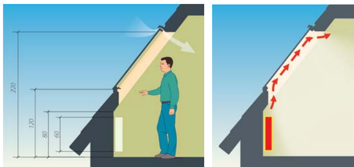
Prawidłowo zamontowane okno
