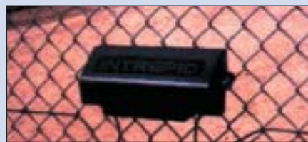
2 Kabel sensorowy mocowany jest do ogrodzenia. Dzięki temu reaguje na jakiegokolwiek próby sforsowania go (fot. Raban)
