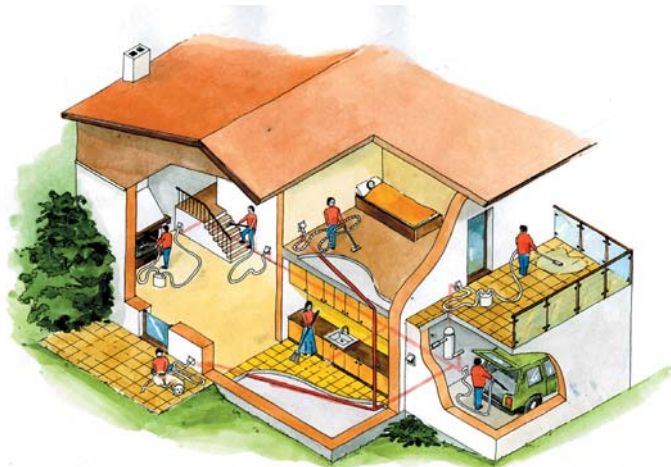
2 Centralnym odkurzaczem można „obsłużyć” cały dom z garażem włącznie (rys. wg Husky)
