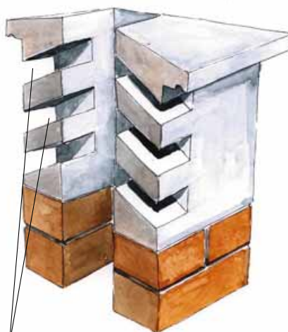
powietrze zasysane przez otwory poprawia ciąg kominowy
