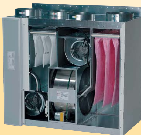
14 Sprawność rekuperatora z wymiennikiem obrotowym dochodzi do 90% (fot. Systemair)
