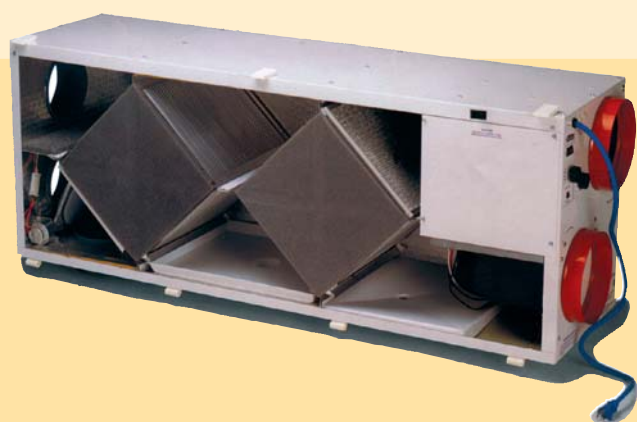
13 Zastosowanie dwóch wymienników krzyżowych zwiększa sprawność rekuperatora do ok. 80% (fot. Ecotherm)
