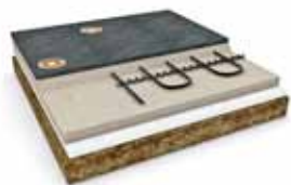
Montaż kabla Tash w asfalcie
