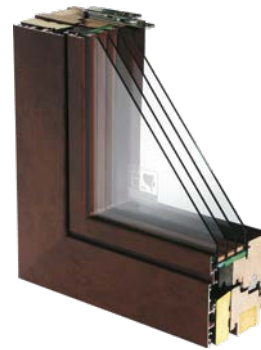
Ultratherm Ultima Głębokość systemu 125 mm, Uw od 0,69 W/m²K.
