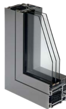
MB 104 Głębokość ramy 95 mm. System przeznaczony do budownictwa pasywnego, U_w od 0,53 W/m 2 K.
