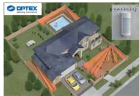
Seria czujek zewnętrznych VX INFINITY umożliwia dopasowanie obszaru detekcji do wymagań użytkownika. Czujkę można zastosować także w systemach bezprzewodowych.
