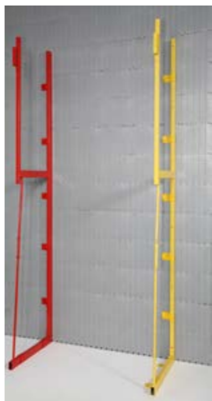
Stalowe podpory ułatwiają budowę ściany, kontrolę płaszczyzn z zachowaniem pionu. Podpory w kolorze czerwonym przystosowane są do montażu nadstawki o wys. 110 cm.
