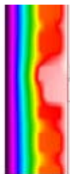
Element wieńcowy MP posiada zewnętrzną warstwę izolacji taką samą jak cała ściana
