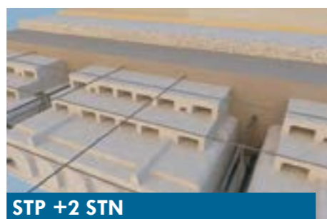
STP Rozpiętość: < 5,5 m, wys.: 25 cm Zużycie betonu: 70 l/m 2
