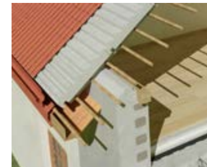
Schemat połączenia płyty dachowej Izodom ze ścianą.
