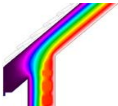
Ilustracja pokazuje bardzo dobrą ochronę termiczną, jaką zapewnia zastosowanie elementu MP przy budowie ścianki kolankowej. Ciągłość warstwy izolacyjnej chroni budynek przed stratami ciepła i wilgocią.
