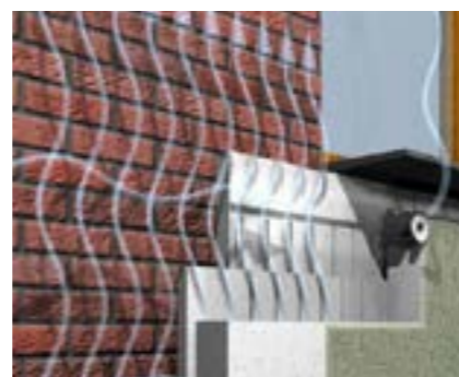
Płyta IZOBETA dociepla i osusza ściany budynków.
