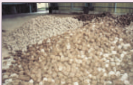
1 Kostka bazaltowa – wyjściowy surowiec do produkcji wełny mineralnej (skalnej) (fot. Rockwool)
