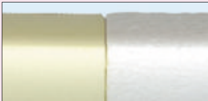
8 Różnica między litą piankową strukturą polistyrenu ekstrudowanego (po lewej, kremowy) i granulową (agregacyjną) styropianu
