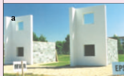
9 Porównanie pożarowego zachowania BSO z użyciem wełny mineralnej (stanowisko MWR) i styropianu (stanowisko EPS); próbę przetrwały oba, ale przewaga wełny po poddaniu działaniu ognia jest wyraźna (fot. Rockwool)
