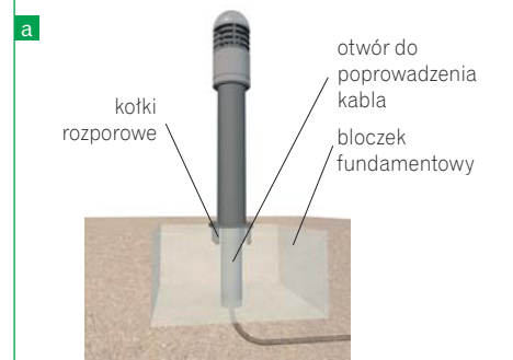
Kinkiety mocuje się bezpośrednio w ścianie lub w słupku (a) albo na ścianie lub na słupku (b)
