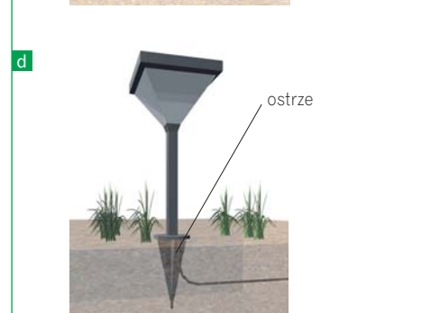
Niskie słupki mocuje się do gotowych bloczków fundamentowych (a), do betonowego fundamentu wykonanego na miejscu montażu (b), do utwardzonej nawierzchni np. z kostki brukowej (c) lub, jeśli słupki są wyposażone w podstawę zakończoną ostrzem, wbija się je w grunt (d)
