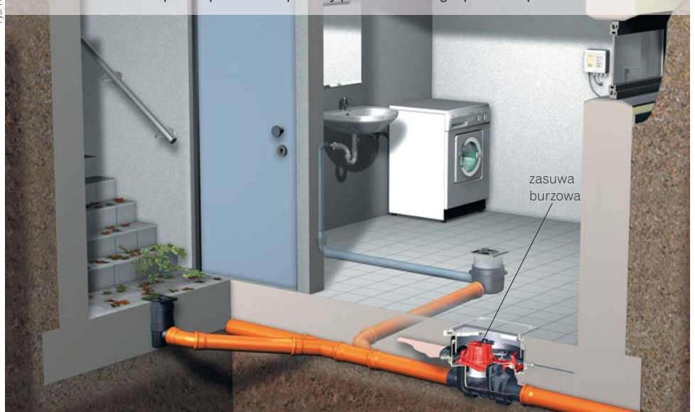
Zasuwa burzowa zabezpiecza położone w piwnicy pomieszczenie gospodarcze przed zalaniem
