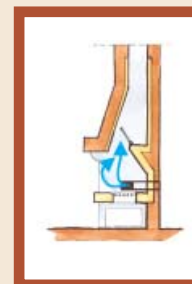
przez boczne ścianki paleniska
