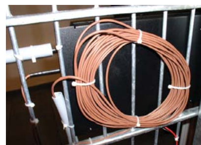
Kabel wibracyjny na płot ▲ i zamontowany na siatce ▼
