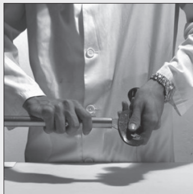
Rys. 20 Gratowanie końca rury
