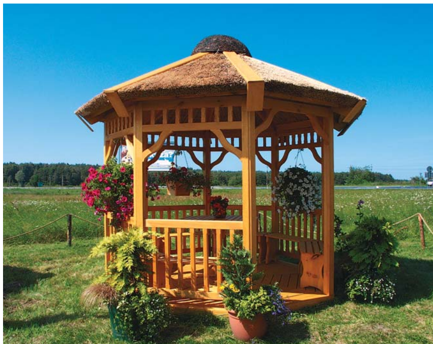
2 Dach pawilonu może być wsparty na drewnianych kratownicach (fot. Silvpol) ▲
