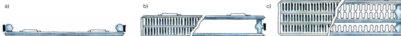
Można wybrać zarówno cienki grzejnik bez ożebrowania – typ 10 (a), najbardziej popularny grzejnik dwupłytyowy z podwójnym ożebrowaniem – typ 22 (b) lub nawet grzejnik trzy płytowy z potrójnym ożebrowaniem – typ 33 (c). Pierwsza cyfra oznacza liczbę płyt, druga – liczbą ożebrowań
