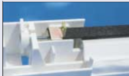
10 Wnętrze nawiewnika higrosterowanego Aereco; po prawej stronie widać taśmę poliamidową, która na zmiany wilgotności reaguje zmianą wymiarów (fot. autorzy)
