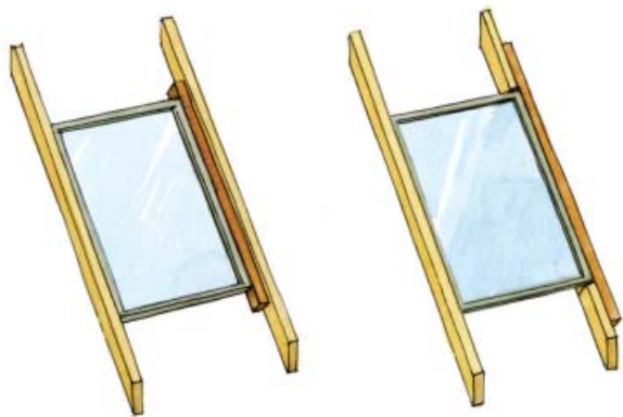
▲ Pogrubienie krokwi – okno nieznacznie mniejsze od ich rozstawu.
