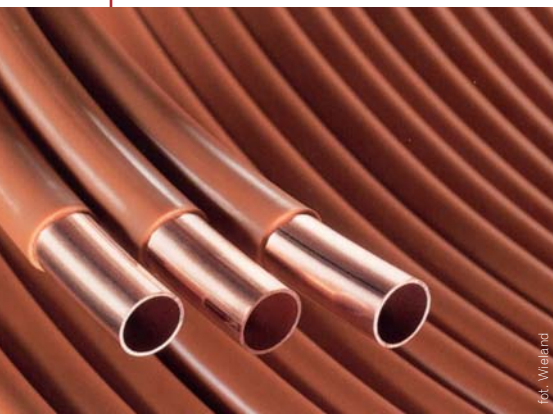
Rury miedziane z płaszczem ochronnym (peszlem) z tworzywa sztucznego, który zabezpiecza je przed uszkodzeniem mechanicznym i chemicznym oraz umożliwia niezakłócone termiczne wydłużanie się rury pod wpływem zmian temperatury czynnika grzewczego
