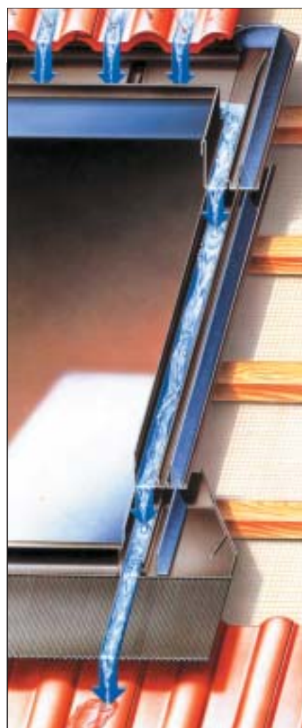
16 Schemat działania uniwersalnego koźnierza dachowego (fot. Velux)
