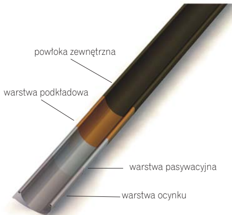
▲ Obecnie orynnowanie stalowe zabezpieczane jest przed korozją kilkoma powłokami
