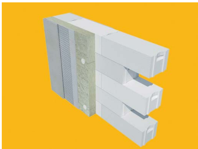
Przekrój muru YTONG gr. 24 cm + docieplenie
