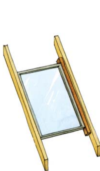
Pogrubienie krokwi – okno nieznacznie mniejsze od ich rozstawu
