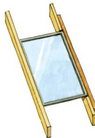
Nadbiecie wyciętej krokwi – okno nieznacznie większe od ich rozstawu
