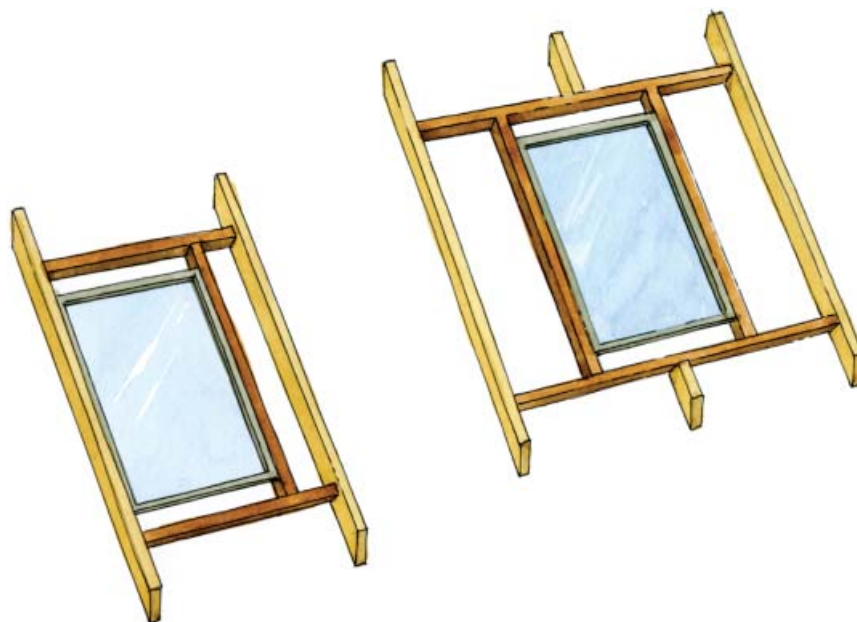
Zastosowanie wymianów – okno znacznie mniejsze lub większe od rozstawu krokwi
