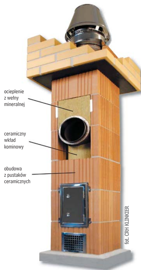
▲ Elementy systemu kominowego ceramicznego
