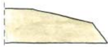
krawędź Norgips S – zmodyfikowana wersja krawędzi KS
