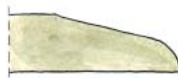
krawędź HRAK – krawędź klasyczna, nadaje się do spoinowania połączeń z użyciem siatki lub taśmy zbrojącej
