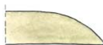
krawędź HRK – krawędź polecana raczej do potąceń bez użycia taśmy zbrojącej
