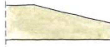
krawędź KS, AK – krawędź skośna, nadaje się do spoinowania połączeń z użyciem siatki lub taśmy zbrojącej
