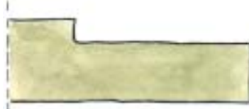
krawędź Rigips Pro – krawędź spłaszczona, nadaje się do spoinowania połączeń z użyciem siatki lub taśmy zbrojącej. Wymaga użycia mas szpachlowych o najwyższej jakości
