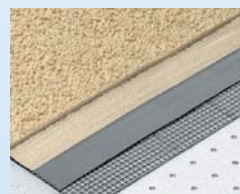
Tynki cienkowarstwowe pozwalają wykonać elewacje w różnych kolorach i o różnej fakturze
