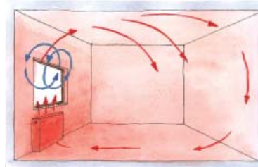
Od miejsca montażu grzejnika zależy sposób przekazywania przez niego ciepła i rozkład temperatury w pomieszczeniu. Najlepiej jest zamontować grzejnik pod oknem
