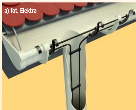
Ogrzewanie przeciwooblodzeniowe stosuje się najczęściej w rynnach (a), na schodach (b) i na podjazdach (c)
