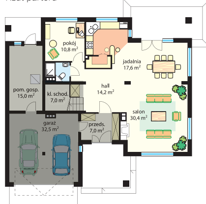
13 W domu piętrowym trudno jest zrealizować zasadę stref buforowych (zwłaszcza na piętrze). Jednak parter obrazowanego budynku dobrze ją prezentuje. Zimny garaż odizolowany jest od cieplej części mieszkalnej za pomocą pomieszczeń takich jak przedśionek, klatka schodowa
