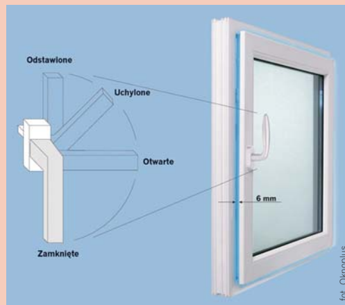
▲ Okucie uchylno-rozwierane z funkcją równoległego odsunięcia skrzydła od ramy, wystarczy przekręcić klamkę o 180°, a na całym obwodzie okna 6-milimetrowa szczelina, gwarantująca naturalne i bezpieczne przewietrzanie przy każdej pogodzie
