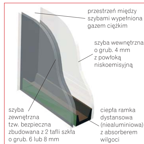
▲ Konstrukcja szyby zespolonej
