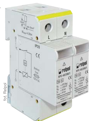
▲ Ogranicznik przepięć klasy C montuje się w rozdzielnicach. Zabezpiecza on instalację przed skutkiem uderzenia pioruna
