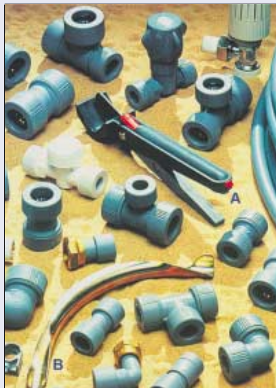
10 Elementy systemu Hep20; oprócz rur, kształtek, złączek itd. widać nożyce do cięcia rur (A) oraz kształtownik (B), w którym układa się rurę w miejscach zagięcia jej trasy pod kątem prostym
