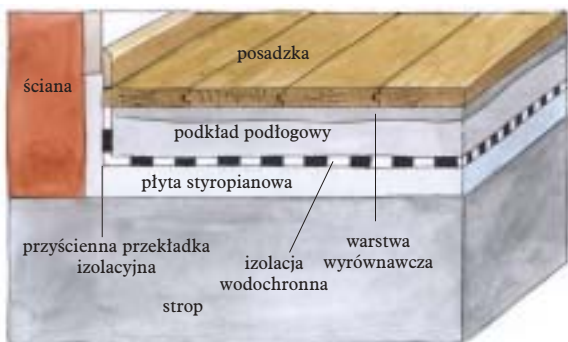
6 Podłoga z izolacją akustyczną z płyt styropianowych
