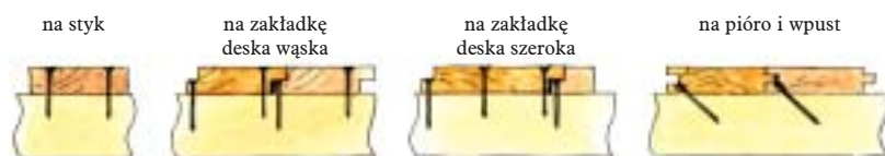
10 Mocowanie desek gwoździami (specjalnymi, o łbie walcowym) do legaru; tam, gdzie łby mogłyby pozostać widoczne, zagłębia się je w drewnie, a kanaliki nad nimi zaślepia drewnianym kołeczkim
