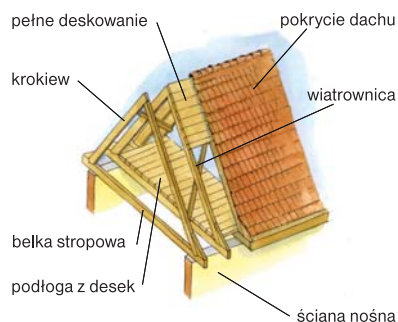
Dach o konstrukcji krokwiowej
