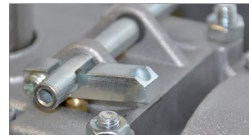
Zewnętrzne wysprężenie dla ręcznego odblokowania
