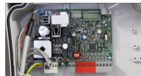
Centrala sterująca CT10224 z wbudowanym wyświetlaczem
