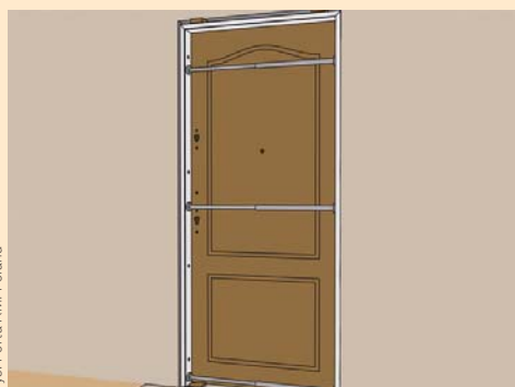
▲ Sposób usztywnienia ościeżnicy podczas montażu
